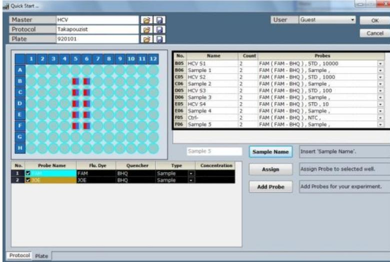
۶. در نهایت همانند شکل زیر به ترتیب بر روی نمای ذخیره در مجاورت هر یک از جعبه های Master ، Protocol و Plate کلیک کنید و در هر بار پس از ظاهر شدن پنجره save as روی گزینه Save کلیک کنید تا تنظیمات وارد شده ذخیره گردند.
